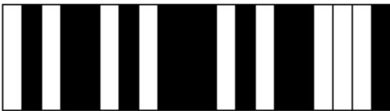
Se o leitor óptico for passado da esquerda para a direita irá ler: 01011010111010110001
