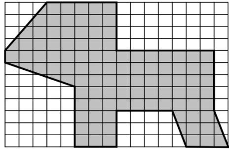
108. Por norma, em cômodos residenciais com área superior a  $6 \text{ m}^2$ , deve-se instalar uma tomada para cada 5 m ou fração (de 5 m) de perímetro de parede, incluindo a largura da porta. Determine o número mínimo de tomadas e o espaçamento entre as tomadas do cômodo abaixo, supondo que elas serão distribuídas uniformemente pelo perímetro do cômodo.
