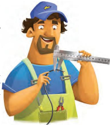
Nesta situação, usa-se um paquímetro graduado em décimo de milímetro como o instrumento mais adequado.
