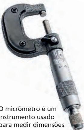
O micrômetro é um instrumento usado para medir dimensões lineares de objetos, como fios de cabelo, com precisão da ordem de  $10^{-5}$  m.
